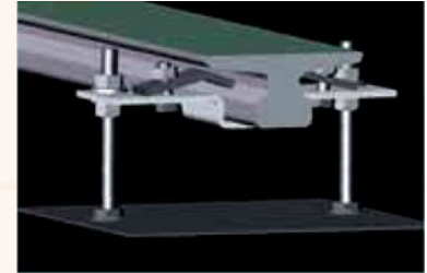
Detalle anclaje Raíl Rodadura. Perfil normalizado A-45
